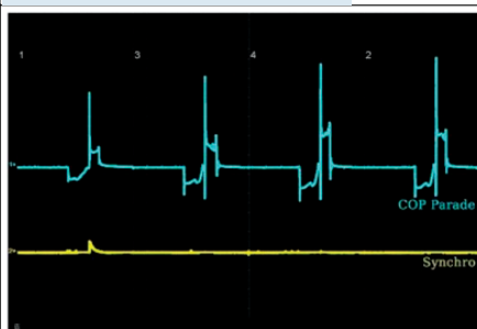
Forma de onda "COP Desfile" com sinal de sincronização do primeiro cilindro
