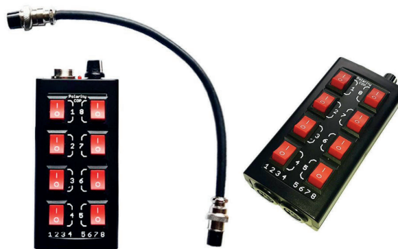
Adaptador COP com cabo específico para o USB AUTOSCOPE IV
