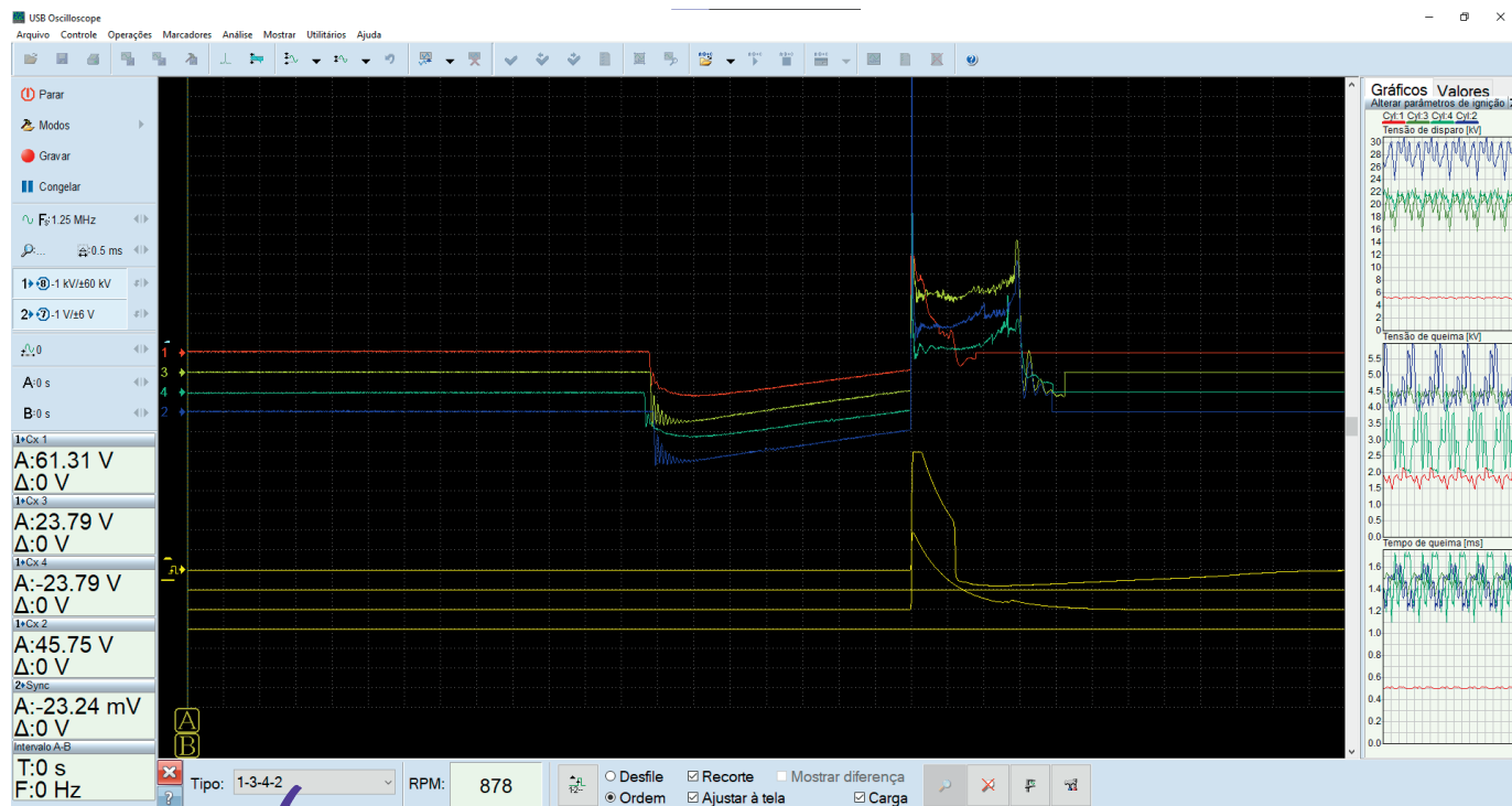
PlugIn "Diagnóstico de ignição", modo "Simultâneo"
